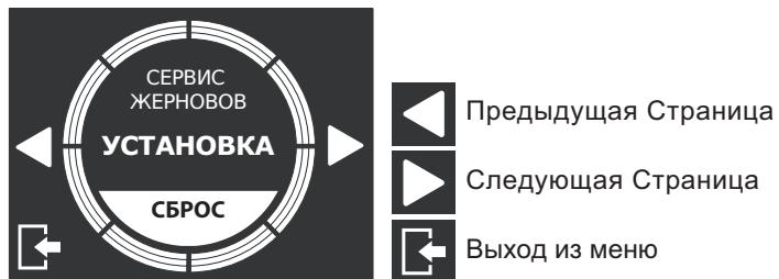
Нажав кнопку **SETTING**, вы получите доступ к меню, чтобы включить / выключить сигнал оповещения об изменении жернов и установить их размер и тип.
