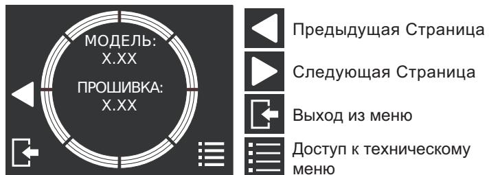
На этом экране отображается информация о машине, относящаяся к модели и версии микропрограммного обеспечения, необходимая для каждого вида технического обслуживания.
