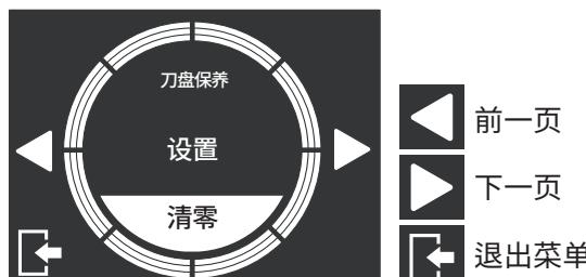
按下 **设定** 键位,就可以访问启用/停用研磨切换警报以及研磨尺寸、类型设定菜单。
